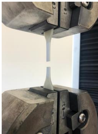
Figura 49 - Foto mostrando a prensa da máquina e o rompimento do material
