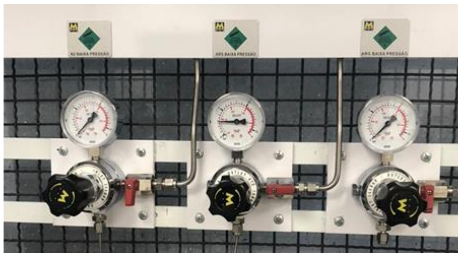
Figura 41 - Ar sintético usado durante aquecimento de amostra para que todo o polímero reagisse com o oxigênio
