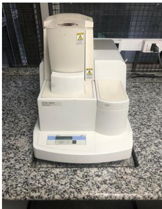
Figura 40 - Equipamento DTG-60H da marca Shimadzu para DTA
