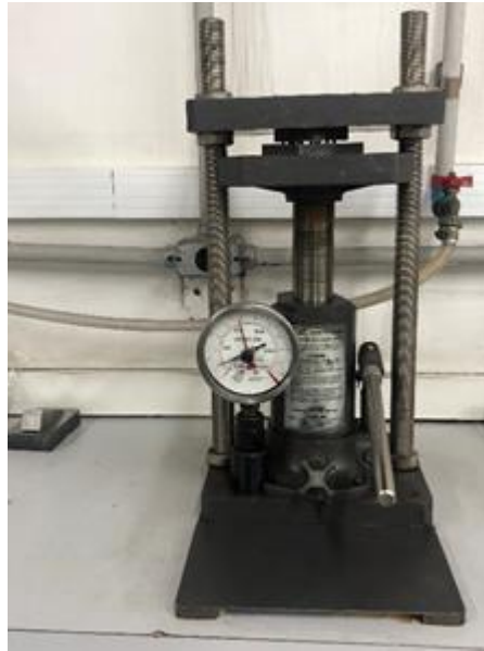
Figura 36 - Prensa hidráulica utilizada para achatar as amostras
