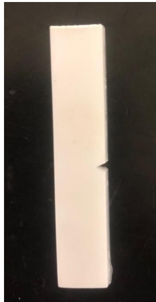
Figura 47 - Amostra de ABS virgem entalhada
