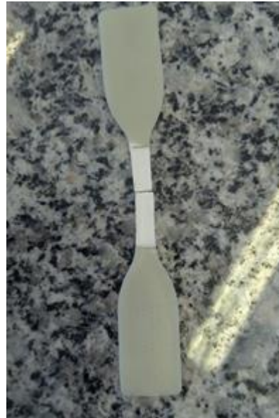
Figura 88 Foto exaltando o crazing na amostra GP35
