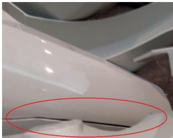
Figura 52 - Peça quebrada após ser pressionada contra o chão. Status: quebrado/reprovado
