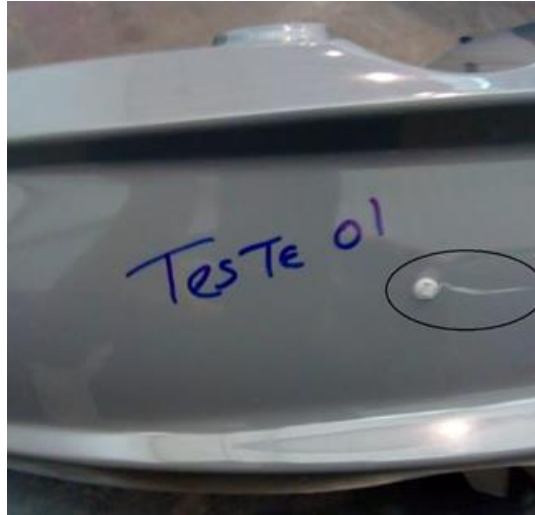
Figura 54 - Peça trincada após ser solta da altura do peito de uma pessoa. Status:suportou/aprovado
