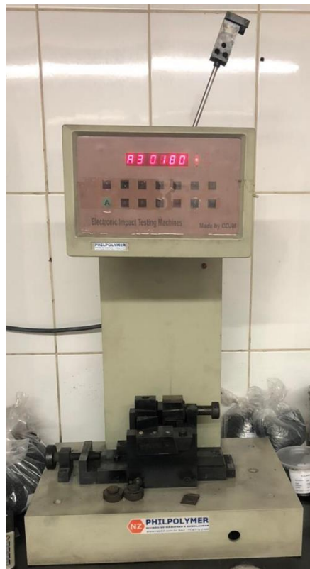
Figura 45 - Máquina "Electronic Impact Testing Machine" usada para teste de impacto
