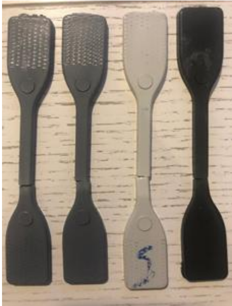
Figura 87 - Foto revelando a quase ausência do mecanismo de crazing nas amostras 01, 06, 07 e 08
