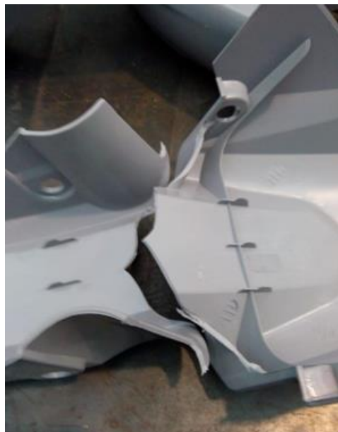
Figura 55 - Peça quebrada após ser jogada da altura do peito de uma pessoa. Status:quebrado/reprovado
