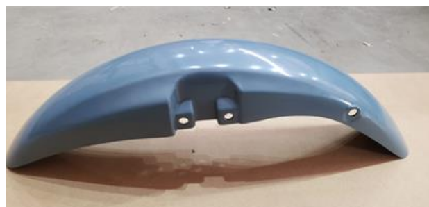
Figura 53 - Peça intacta após teste de impacto/ser jogada ao chão da altura do peito. Status: suportou/aprovado
