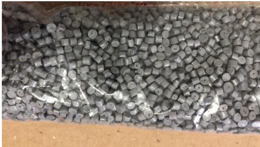
Figura 34 - Grânulos de um dos ABS reciclados
