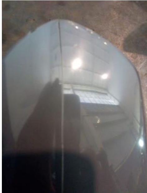
Figura 51 - Peça trincada após ser pressionada contra o chão. Status: trincado/parcialmente aprovado
