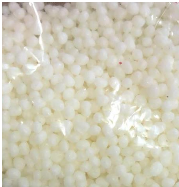
Figura 35 - Grânulos do ABS GP35 (virgem)
